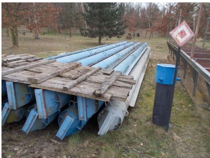
Pohled na provizorní hrazení, hradidla vlevo, lávky vpravo
