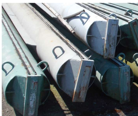
Hradidla uložení na skládce a detail těsnění
